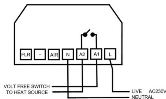
3, Свързване към кабелния – клемна шина
