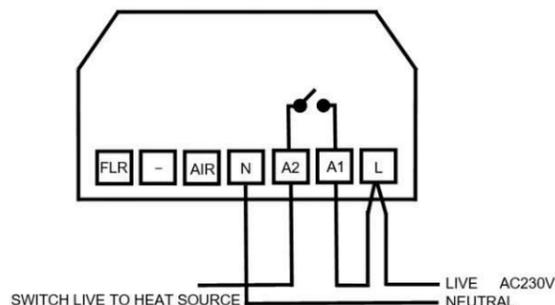
„2. Безпотенциален превключващ контакт за отоплителния елемент
